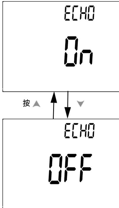
图 4-14 远程控制的回波模式设置
